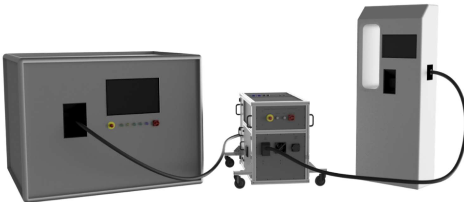
Abbildung 2: Prüfaufbau bestehend aus der Ladeeinrichtung (rechts), dem Messsystem (Mitte) und dem Autosimulator (links)
